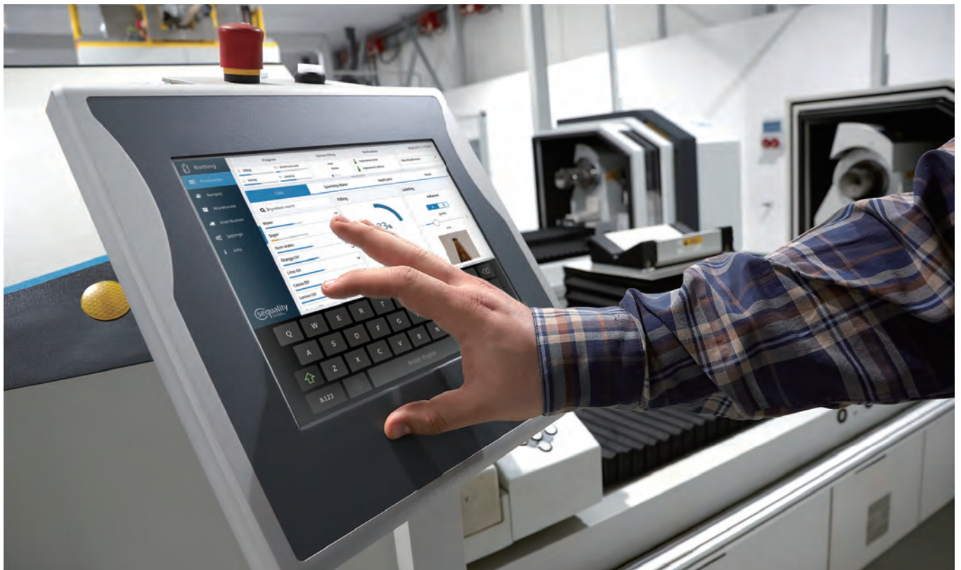
図10: HTML5 sequality- 瓶詰め工場向け組み込みLinuxターミナルのQtWebViewのデモアプリケーション。
